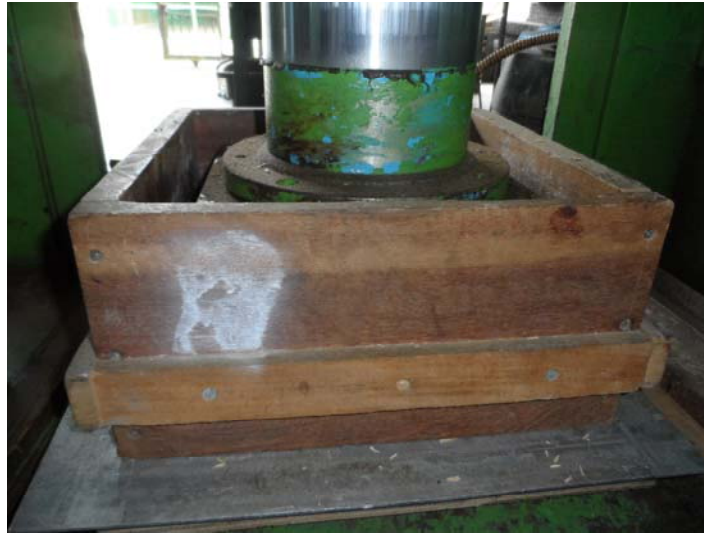
Gambar 20 : Memampatkan bahan tadi menggunakan mesin pemampat (cool press)
