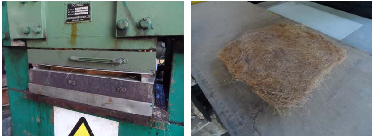
Gambar 22: Proses pemampatan Hot Press sedang dilakukan dan 'Artificial Top Soil' yang dihasilkan
